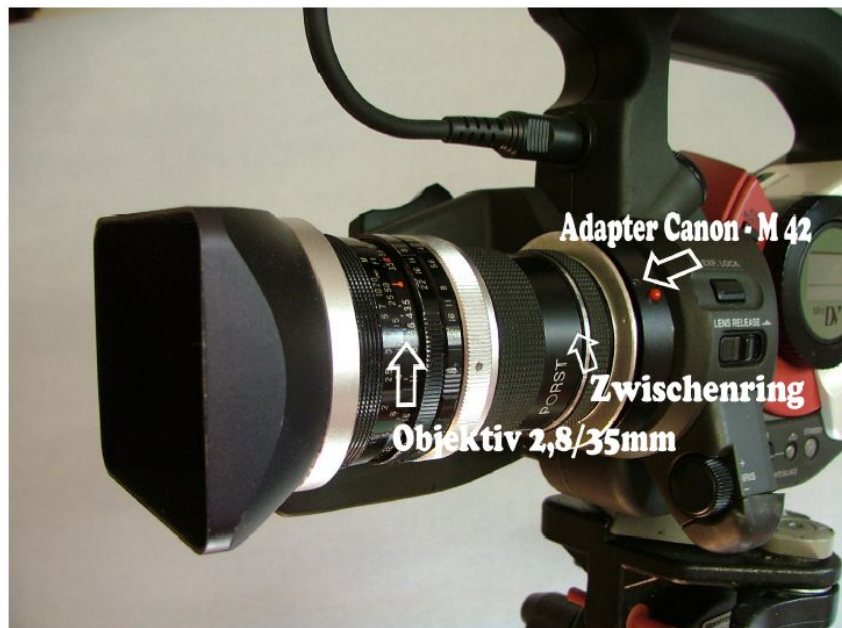
Kamera mit Zwischenring und Objektiv
